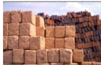
Distintos materiales de bajo costo. Tepetate (tova volcánica) para muros. Y ladrillo cuña (5x10x20 cm) para cubiertas.
